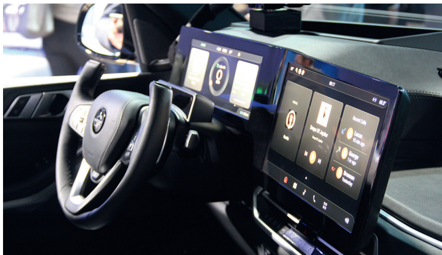
Bild 1: Ready Care ermöglicht eine Echtzeit-Messung der visuellen und mentalen kognitiven Belastung des Fahrers. Anhand der durch neurowissenschaftliche Erkenntnisse gestützte Analyse der Augenaktivität und des Geisteszustands wird erkannt, wenn der Fahrer mental abgelenkt ist. © Stefanie Eckardt | HANSER automotive
