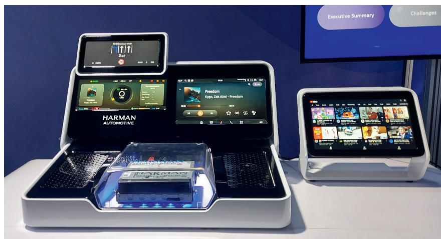
Bild 2: Ready Upgrade umfasst drei Familien von serienreifen Cockpit Domain Controllern, ein komplettes Kombiinstrument und einen IVI-Software-Stack. © Stefanie Eckardt | HANSER automotive
